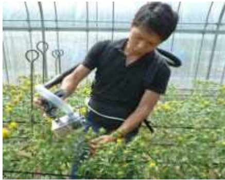
写真 25 小型花卉収穫機（試作） による収穫試験
