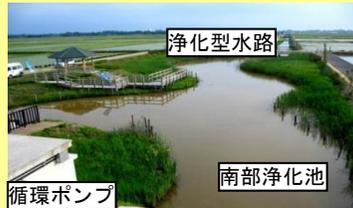
排水は浄化型水路に流入し、浄化池から循環ポンプでくみ上げ再び農業用水として利用。
