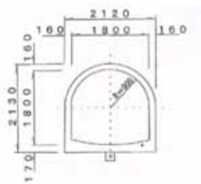
参考 2-12 幹線水路(ずい道) 標準断面図
