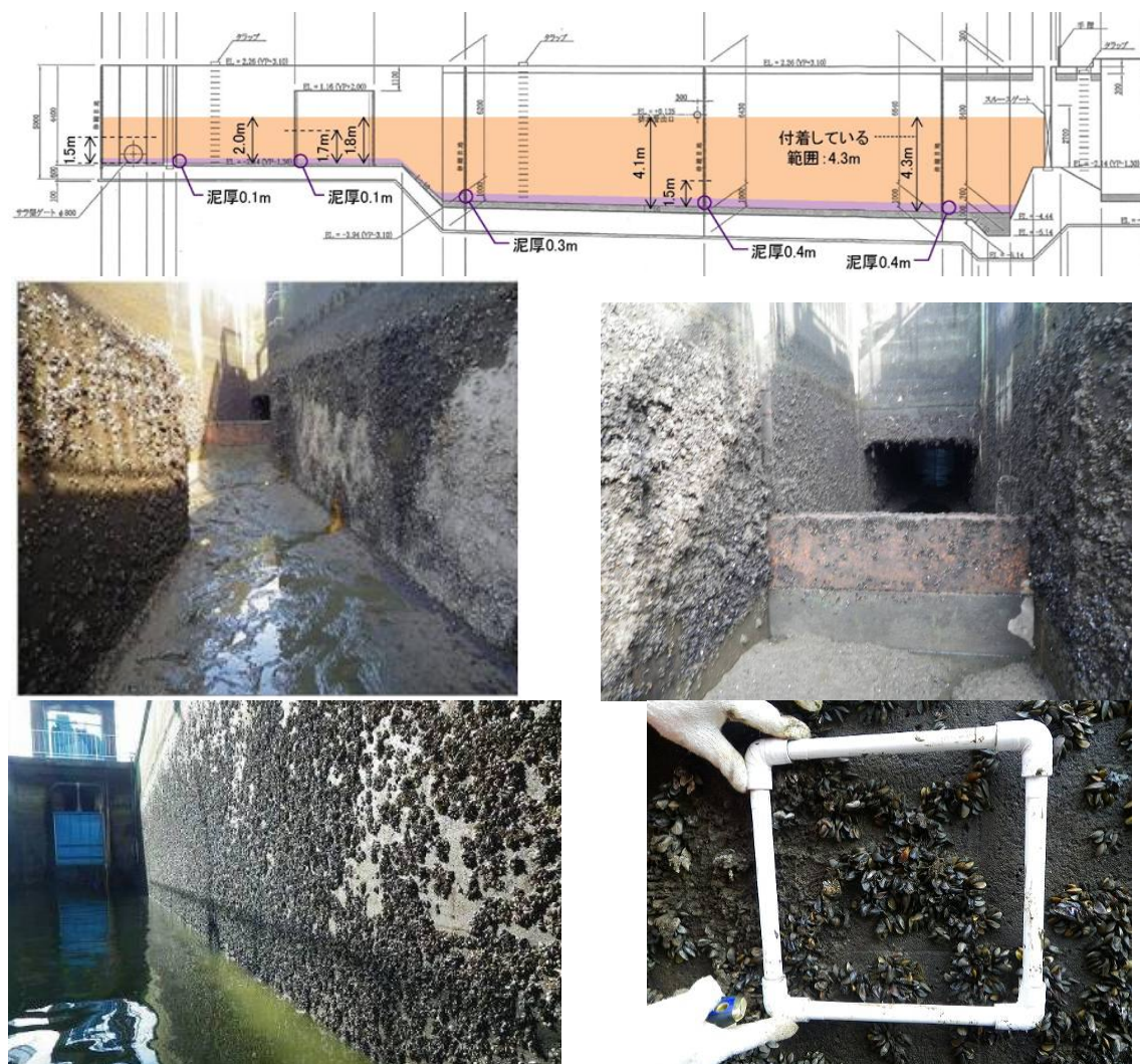
図 14 カワヒバリガイの固着状況（常時水深まで貝が付着）
