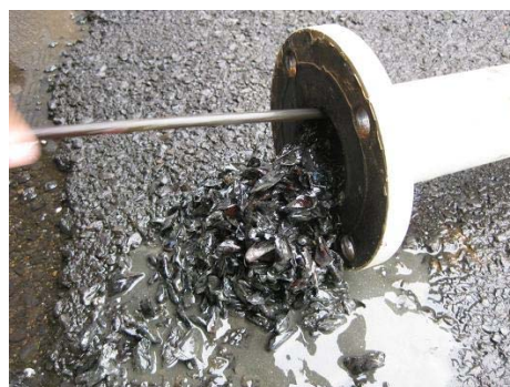
図18 保圧タンクの内部と配管に入り込んだカワヒバリガイ
