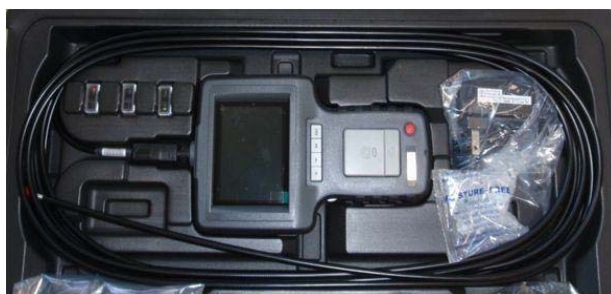
図 31 工業用内視鏡による調査
