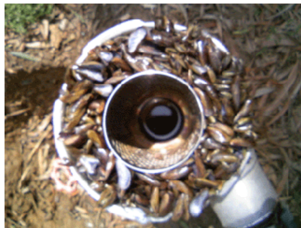
図 21 給水栓の閉塞及びストレーナーにおける目詰まり状況（死貝）
