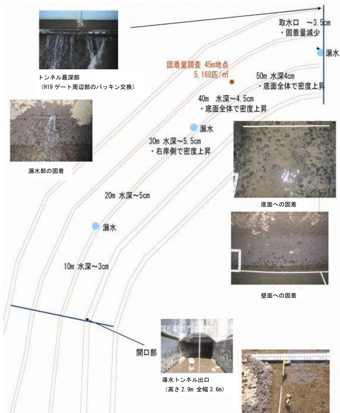
図 15 カワヒバリガイの付着状況（隧道内での明暗環境での付着密度の違い）（mは下流側開口部からの距離）
