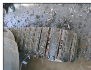
図 47 樹脂製アタッチメントとゴム製クローラーを装着した重機による駆除
