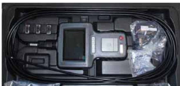
図 31 工業用内視鏡による調査
