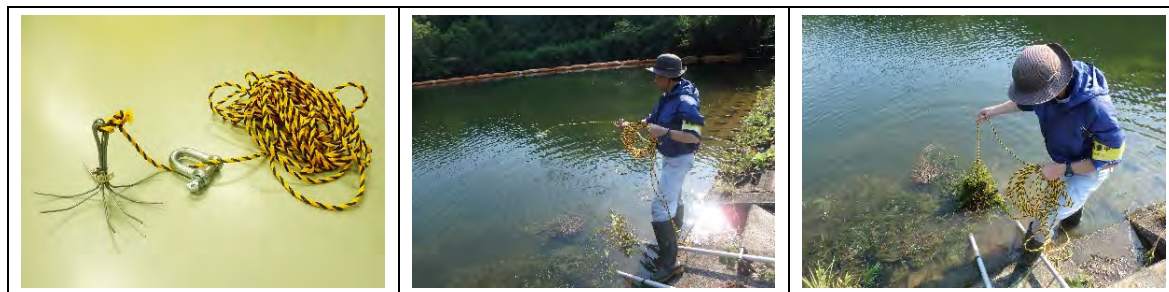
図 1-33 アンカー型水生植物採集器による水草の採集
