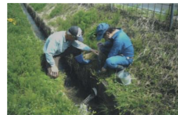
排水の透視度調査
