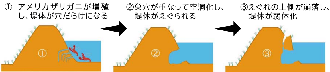
図 2-13 アメリカザリガニの巣穴による「ため池堤体の損壊」事例(山口県山口市)
