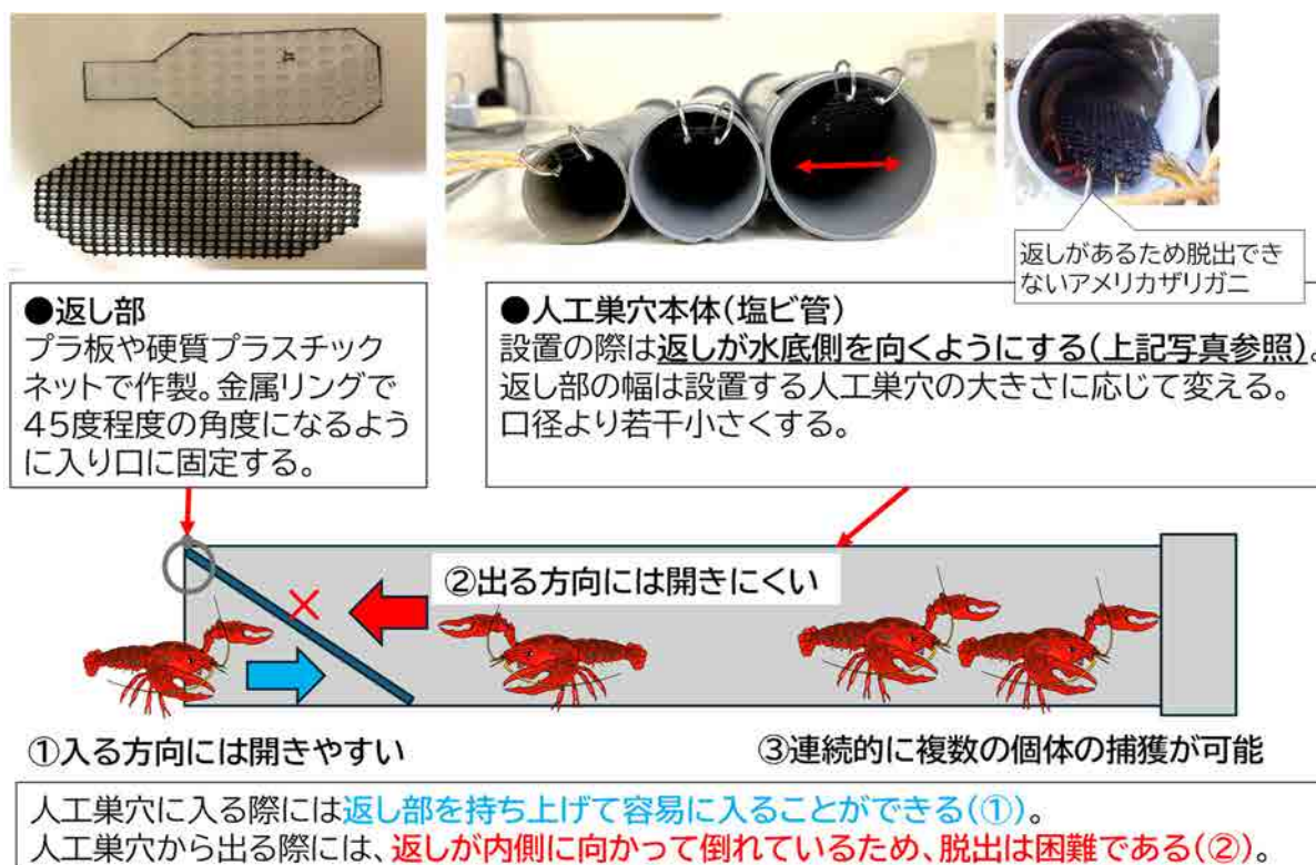
図 3-20 実証調査で用いた返し付き人工巣穴の構造
