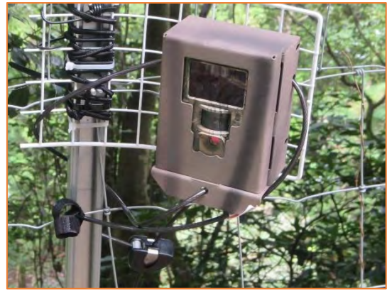
センサーカメラの盗難防止対策実施例
