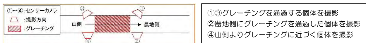
センサーカメラ設置位置（例）
