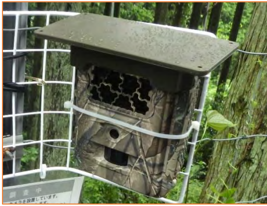
センサーカメラの防水対策実施例
