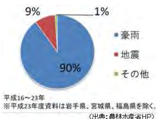
図 2 ため池の被災原因
