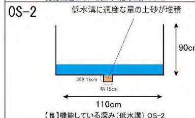
適度に土砂が堆積している低水溝
