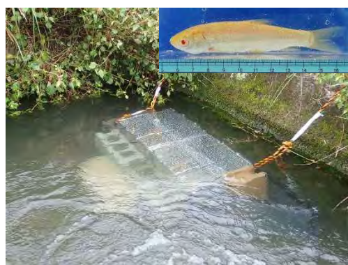
実験魚の入ったカゴの設置状況 (右上は実験魚のアルビノ型ソウギョ)
