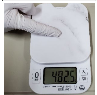
写真2 押し付ける強さの測り方
