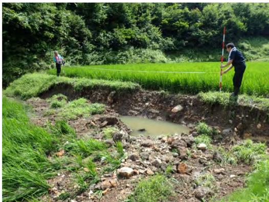
写真1 ポールを置き農地を含めた全景写真の例
