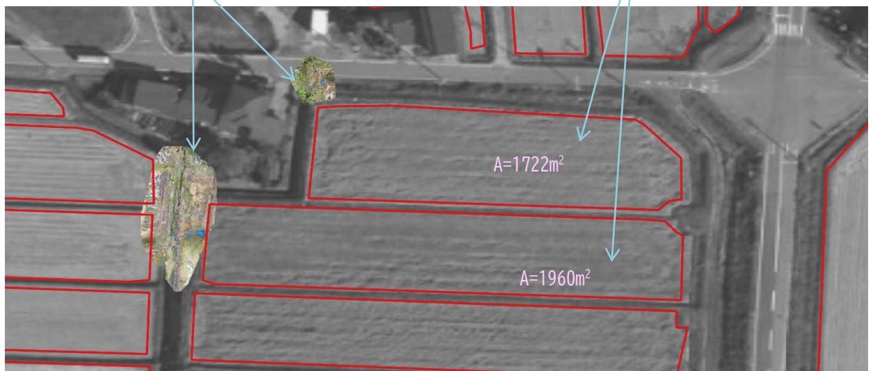
図 3-66 三次元データのGIS上で表示し、水張面積を算定 (背景は地理院地図の航空写真(グレースケール表示)と農地ポリゴン(赤線))
