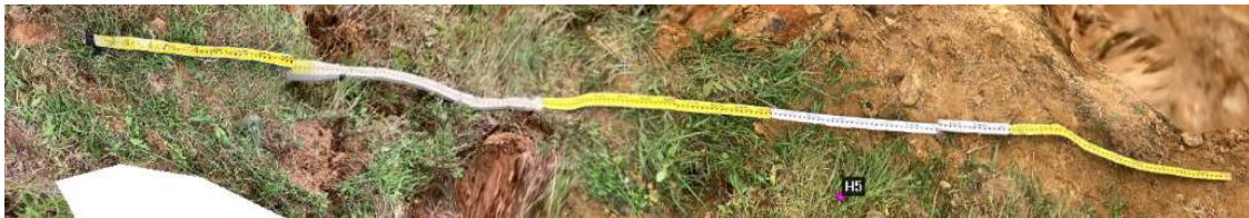
図4-5 歪みや欠測が生じているポール、スタッフの三次元画像
