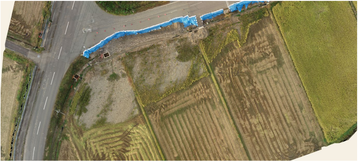
図3-39 オルソ画像による堆積状況 (トラクターの走行部と土砂堆積部がある程度明確になっている)
