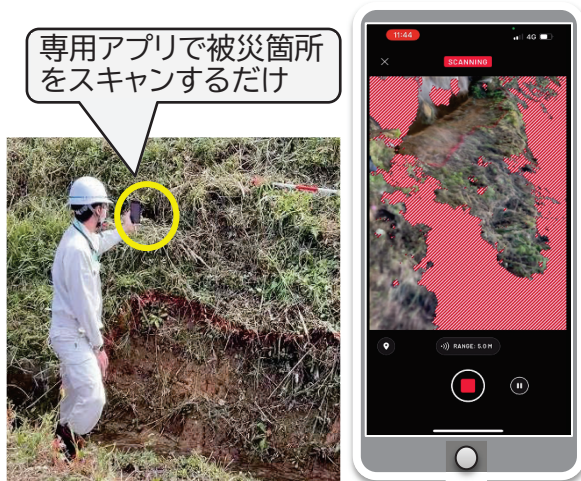
図3-4 スマートフォン等による三次元測量
