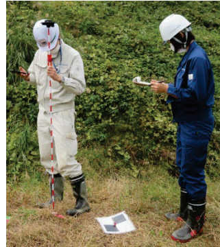
図3-13 安価なGNSS受信機(ビズステーション(株) RWP)と作業風景
