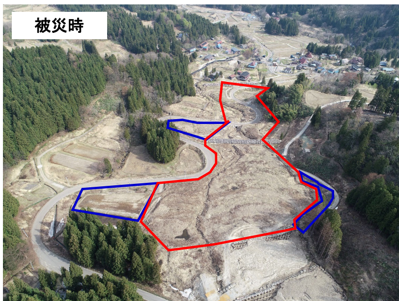
地すべりによる土砂堆積
