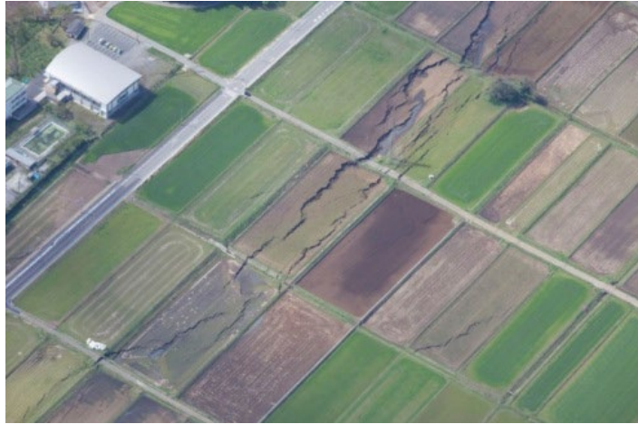
写真 2-8-1 水田のき裂被害(熊本地震(H28.4))
