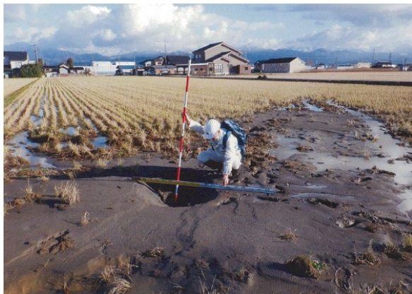
写真 2-8-3 水田の液状化による噴砂被害(能登半島地震(R6. 1))
