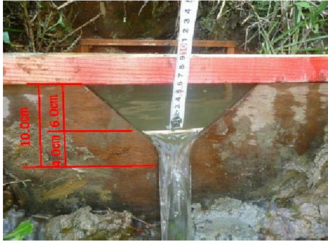
写真 2-8-5 三角堰による漏水量調査
