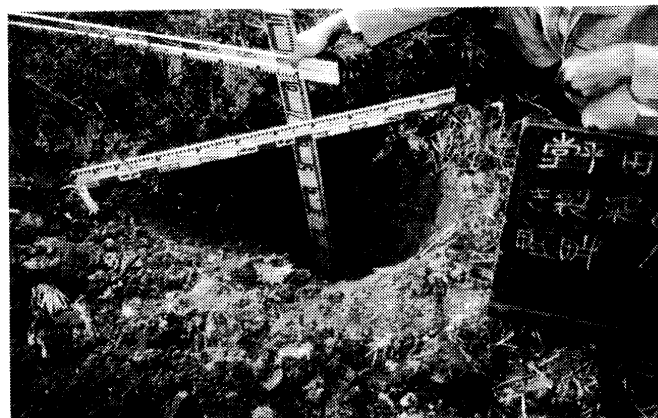
写真 2-7-2 干ばつによるき裂深測定状況
