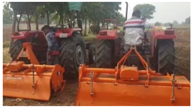
株式会社太陽と現地企業それぞれの 耕うん爪を装着したトラクターによる比較実証
