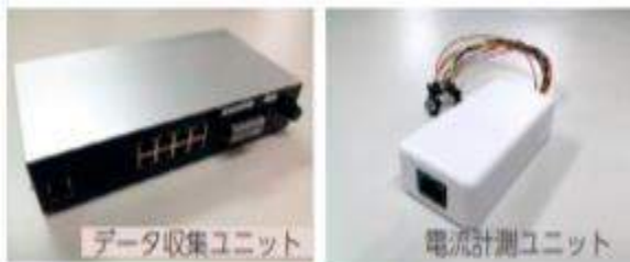
電力計測システム
