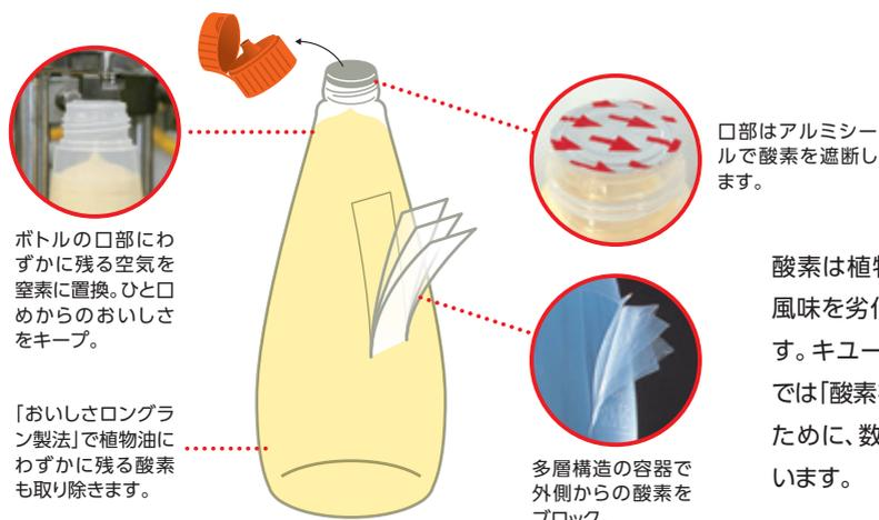
ボトルの口部にわずかに残る空気を窒素に置換。ひと口めからのおいしさをキープ。
