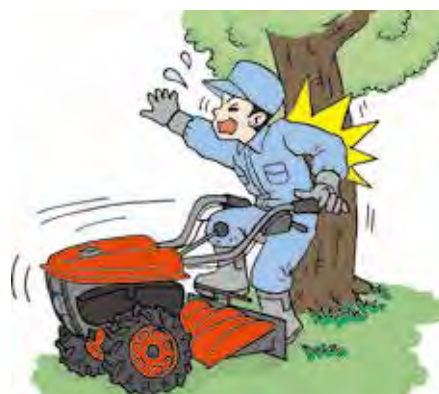
バックによる挟まれ事故（樹木）
