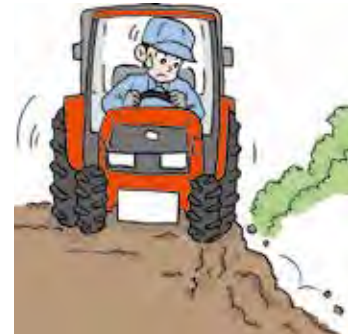
崩れやすい路肩もある
