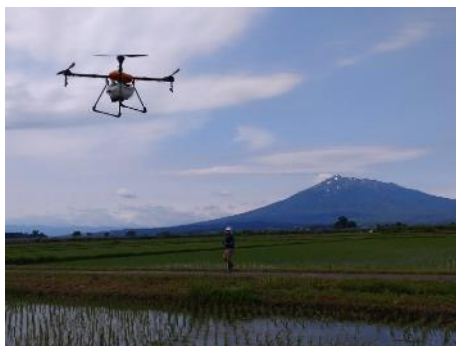
ドローンによる防除作業
