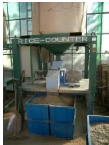
粳ごと破碎できる破碎機 (RICE-COUNTER)を自ら開発
