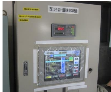
自家配合飼料工場にて専用 サイロからコンピューター制 御で自動配合
