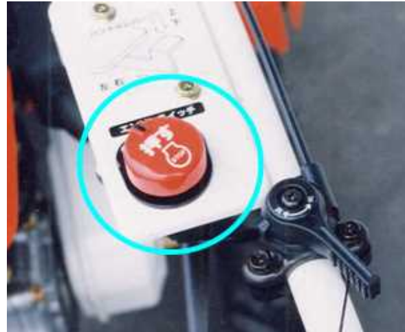
緊急停止ボタン
