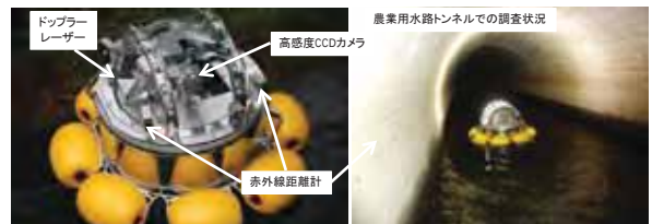
【点検ロボットの開発（無人調査）】
