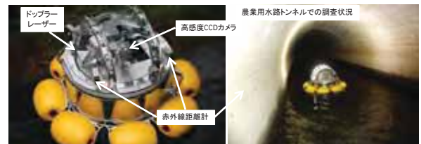
【点検ロボットの開発（無人調査）】
