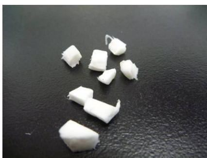
図 2-3 5mm 角に試料を裁断する
