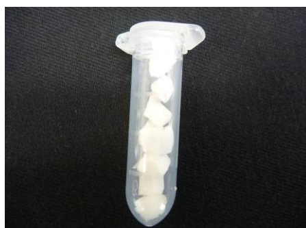
図 2-4 2ml チューブに試料を入れ完成
