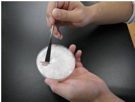
図 3-1 スパーテルを用いて菌糸を集める
