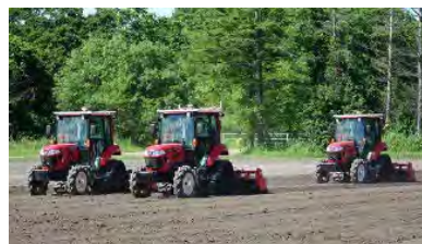
自動操舵機能付き農業機械（トラクター・田植機）
