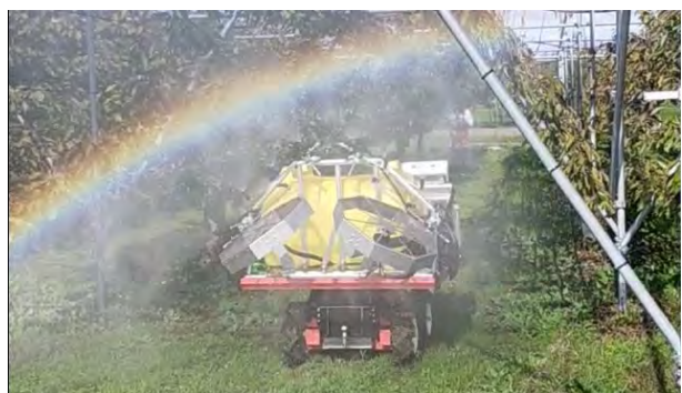
動噴とタンク、ファンを搭載し薬品散布しながら走行
