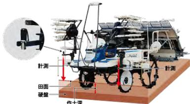
田面までの距離を計測し、車体の沈下量から作土深へ換算します。
