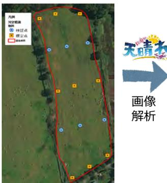
※評定点を置きドローン撮影 (※高精度測量プラン時のみ)
