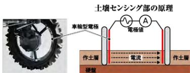
車輪のリム内に電極センサが埋め込まれている。
