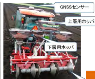
高速2段局所施肥機 転圧ローラー 2段局所施肥イメージ図
