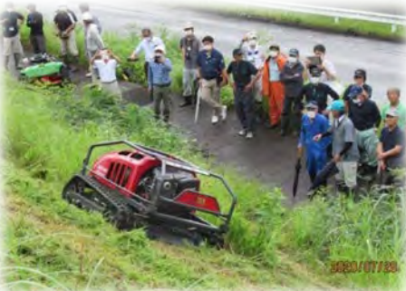
ラジコン草刈機の現地実証の様子
