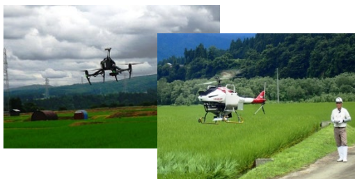
ドローンによるセンシング +ラジヘリによる可変追肥
