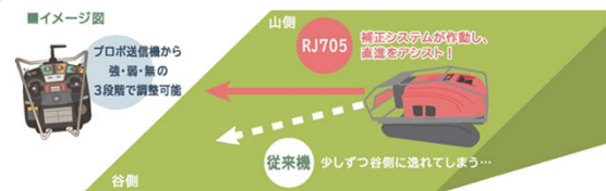
斜面補正システム搭載 傾斜角度を検知し、角度に応じて直進補正量を自動で調整。（平地では自動で補正をOFF！）
