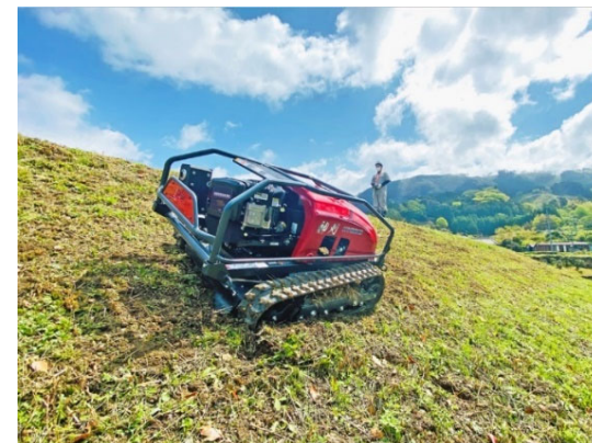
斜面補正システム搭載 傾斜角度を検知し、角度に応じて直進補正量を自動で調整。（平地では自動で補正をOFF！）
