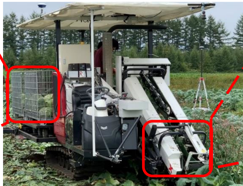
A I でキャベツを認識し、自動収穫
