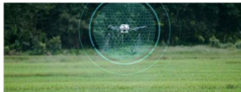
全方向3次元での探知が可能 球面型全方位レーダー
