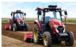
無人運転+随伴トラクターによる2台協調作業
