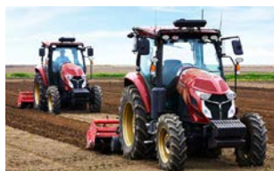
無人運転+随伴トラクターによる2台協調作業
