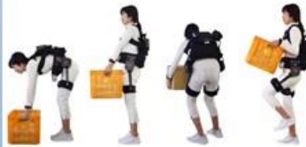
持ち上げ時 10~15kg分 腰のアシスト 持ち下り時 ブレーキで 腰のアシスト 中腰作業時 姿勢保持で 腰のアシスト 歩行時 股関節 アシスト
