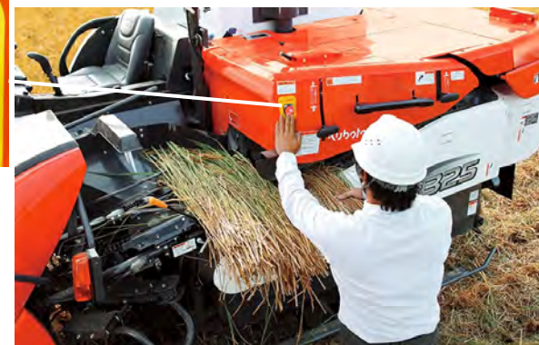
手こぎ作業時のフィードチェーン緊急停止 資料：株式会社クボタHP
