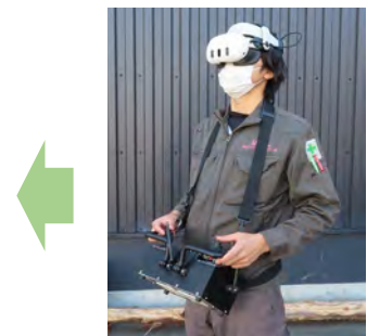
車載カメラの映像を立体視投影するスマートグラスと操作用のコントローラー
