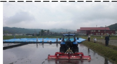
水による土壌攪拌・除去(水田)
