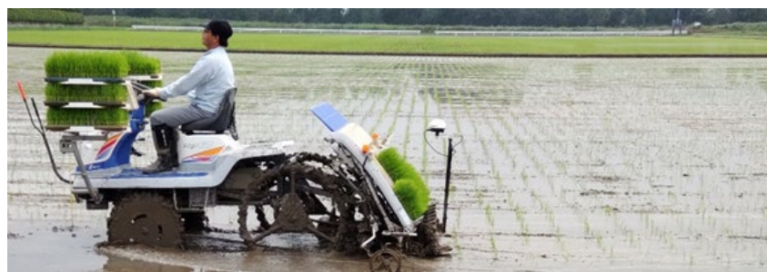
図 12 両正条田植機による田植えの様子
