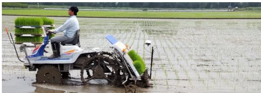
図 12 両正条田植機による田植えの様子
