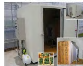
蒸熱処理装置
