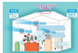
半閉鎖型換気システム
