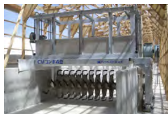
堆肥自動攪拌機
