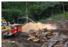
バイオマス燃料を山土場で 効率的に生産する移動式チップパー
