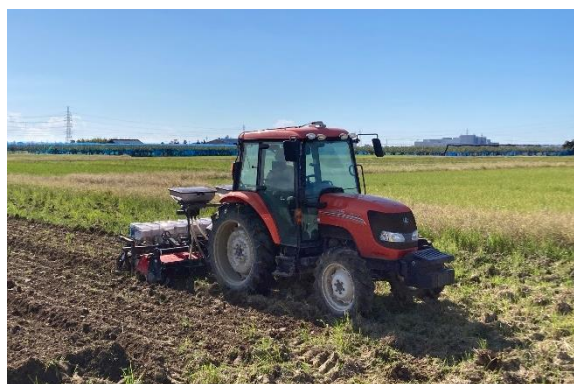
自動操舵システムによる大麦の播種作業
